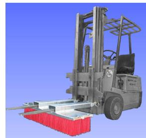
Die **Schiebebürste** ist ein rein mechanisches Anbauteil für z.B. Traktoren, Radlader oder Gabelstapler. Dabei ist die Besonderheit, dass der Kunde Bürsten und Aufnahmeschiene kauft und mit etwas handwerklichem Geschick selbst sein für ihn passendes Anbaugerät baut. Dabei können die Kehrbreite, die Anzahl der Besen hintereinander und die Aufnahme für das Fahrzeug individuell gestaltet werden. Für jeden Einsatzzweck kann eine optimale Lösung gefunden werden.
